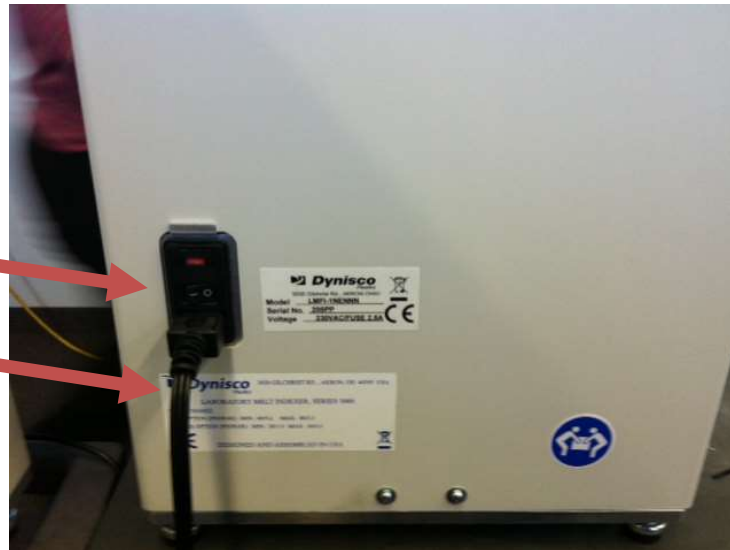
Image 3 : Vue arrière du LMFI ; Prises électriques
