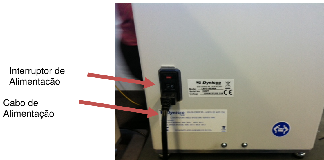
Figura 3: Vista traseira do LMFI Ligações elétricas
